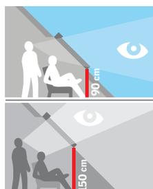
prozor sa **gornjim** upravljanjem za ugradnju na **niskom** parapetnom zidu
